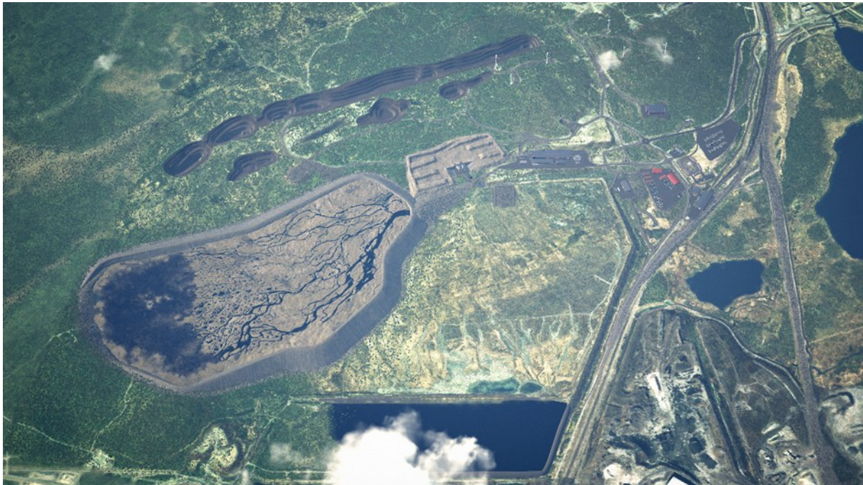
Figur 2. Översiktlig, schematisk bild av kommande verksamhet. Dagbrotten kommer placeras i norr, och underjordsgruvan utgår därifrån. Ett nytt sandmagasin kommer att konstrueras till väster, medan industriområdet kommer att ligga till öster. Längst i söder ligger klarningsmagasinet.
